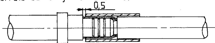
Engager l'ensemble et central/câble en butée dans le corps, la tresse sur le fût.
